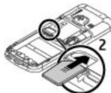
3 Следя за расположением контактов аккумулятора, вставьте аккумулятор.
