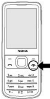
Для включения или выключения телефона нажмите клавишу включения и удерживайте ее нажатой.
