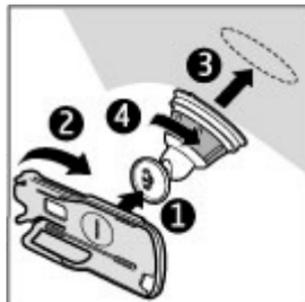
Для отсоединения держателя от крепежного устройства поверните его против часовой стрелки.
