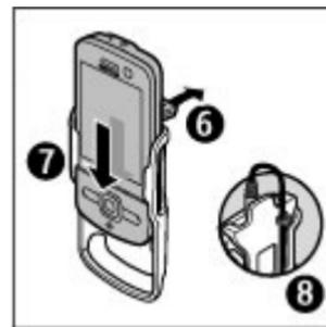
Для зарядки аккумулятора устройства используйте совместимое зарядное устройство. Для подсоединения кабеля зарядного устройства к задней панели держателя вставьте кабель в прорезь в держателе кабелей и подключите разъем зарядного устройства к разъему для зарядки сверху устройства.
