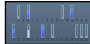
Если устройство обнаружило спутники, для каждого из них на экране информации о спутниках отображается прямоугольник. Чем выше показания шкалы, тем сильнее сигнал спутников. Когда устройство получает от спутников достаточное для вычисления местоположения количество данных, цвет шкалы изменяется.
