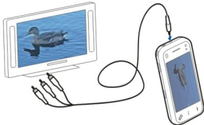
Когда к устройству подключен соединительный видеокабель Nokia, все звуковые сигналы, в том числе активные вызовы, стереозвук видеоклипов, сигналы клавиатуры и мелодии, перенаправляются на телевизор. Микрофон устройства работает как обычно.
